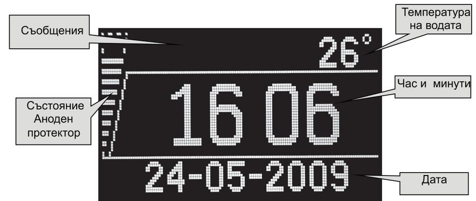
В този режим бойлерът няма да загрева водата. На дисплея са изведени температурата на водата в долната част на водосъдържателя, текущия час и дата и състоянието на анодния протектор.
