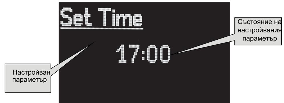
Подобен вид има дисплея по време на всички режими за настройка на работните параметри. На снимката е даден режима за сверка на часът. Тези стойности или числа които ще се променят при натискане на бутоните със
